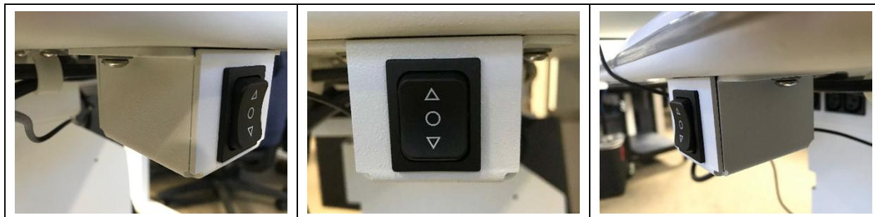
**Figura 1.** Interruttore su/giù tavolo motorizzato PLEX Elite 9000. Evitare qualsiasi contatto con l'intero involucro metallico (incluse le viti di montaggio) che circondano l'interruttore su/giù in plastica nera.
