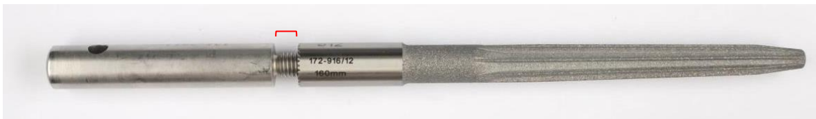
Figura 1: La guida di fresatura non si avvita completamente nello stelo / Figure 1: Reaming guide can't be screwed into stem completely
