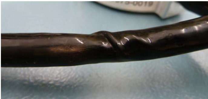
Figura 7: Cavo Motore danneggiato
