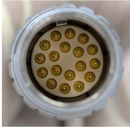
Figura 2: vista del Pin del connettore del motore
