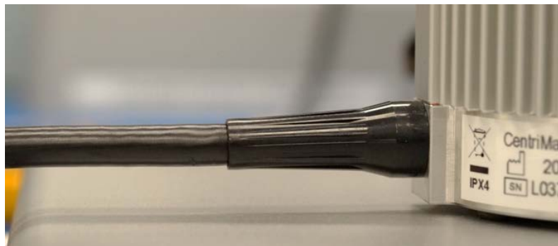
Figura 4: Dispositivo anti piega del cavo connesso al motore
