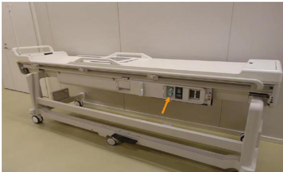
**Fig. 5:** Quando il DISC viene preinstallato in fabbrica, i connettori del tubo sono posizionati nel pannello dei connettori del piano portapaziente.
