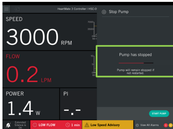
Figura 2: La barra di avanzamento rossa "ARRESTA POMPA" compare sulla linea nera indicando che la sequenza è IN CORSO . Non staccare il System Controller o l'Adattatore Wireless.
