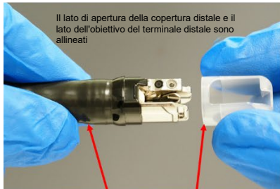
Figura 1: allineare la copertura distale e la punta dell'endoscopio
