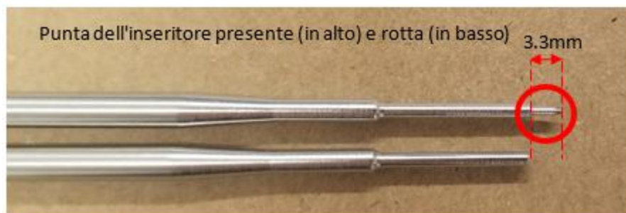
Figura 1. Inseritore e punta dell'inseritore in acciaio inossidabile di grado chirurgico (3,3 mm di lunghezza x 0,97 mm di diametro)
