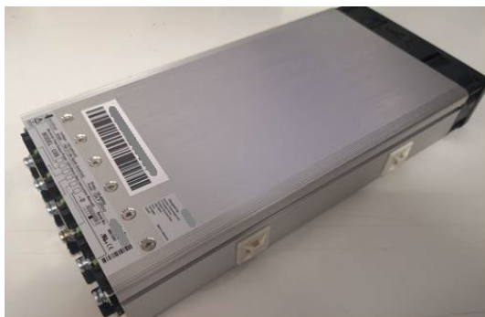
Figura 1: unità di alimentazione non conforme
