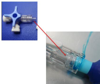
Figura 1: Possibile sito della perdita dal componente che alloggia la valvola
