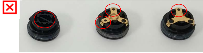
Tappi batteria danneggiati - non utilizzarli. Il contatto metallico non è presente oppure non sono presenti tutti e tre i fermi in plastica nera.
