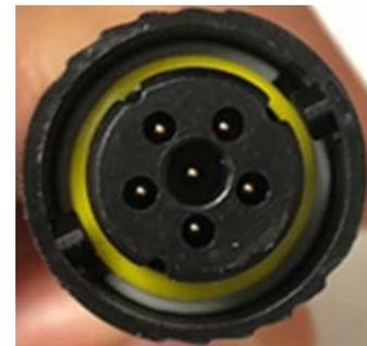
Figura 2 - Vista frontale dei connettori della fonte di alimentazione
