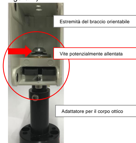
Figura 2: vite potenzialmente allentata che collega il braccio orientabile al corpo ottico
