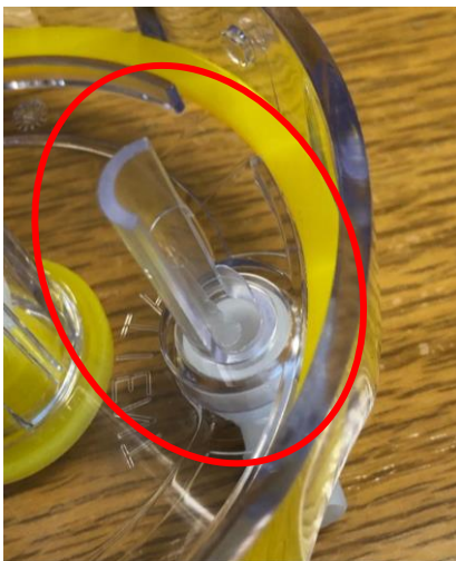
1 Coperchio del contenitore difettoso
