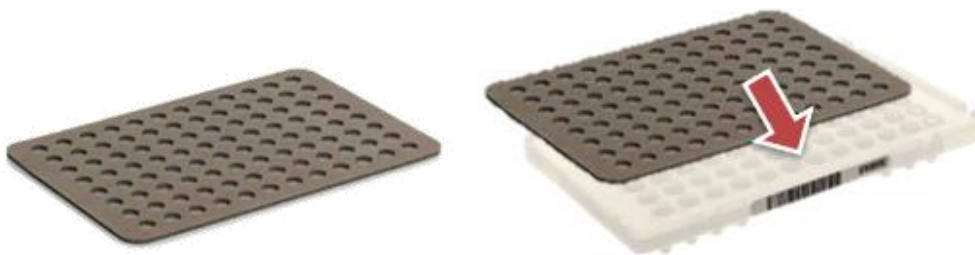
Figura 1: Cuscinetto di compressione MicroAmp Optical Film (sinistra) e posizionamento del cuscinetto di compressione su una 96-well MicroAmp Reaction Plate (destra). Il lato grigio deve essere sempre posizionato verso il basso e il lato marrone verso l'alto.
