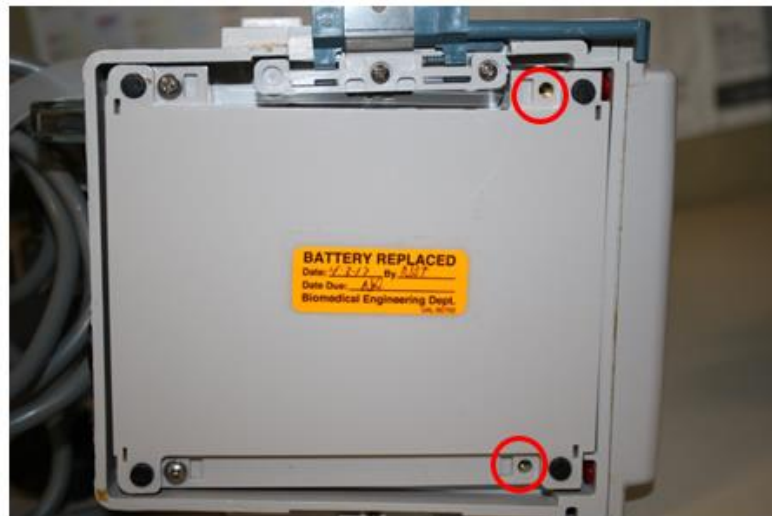
Figura 4: parte inferiore dell'unità PC Alaris™ con in evidenza 2 viti e rondelle mancanti
