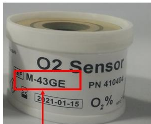
Figura 5: Numero di parte del sensore dell'ossigeno: 6600-1278-600 Figura 6: Numero di parte del sensore dell'ossigeno: M-43GE
