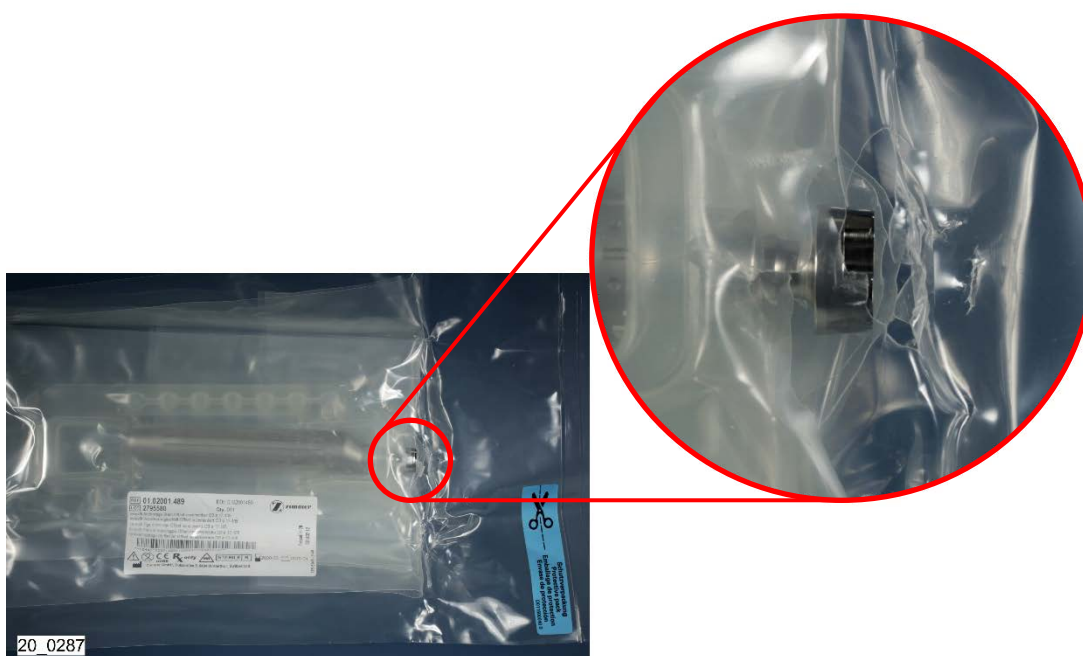
Figura 1: Confezione danneggiata dello stelo di ancoraggio Innex
