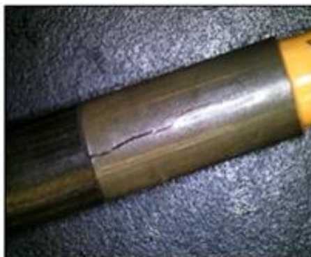
Figura 2. Esempio di incrinatura rilevata sugli strumenti MCS danneggiati
