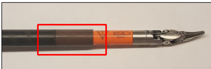
Figura 1. MCS da Vinci S/Si EndoWrist con il bordo prossimale del tubo di prolunga evidenziato.
