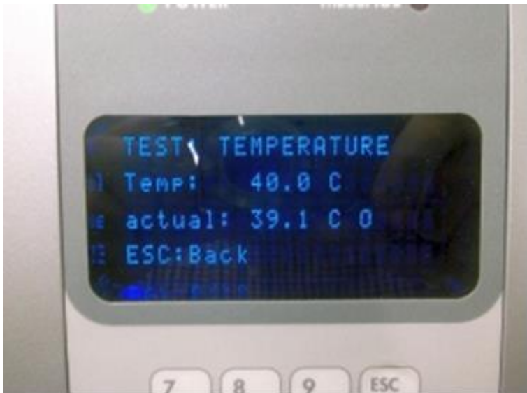
Figura 1. Display EZ1 Advanced XL a seguito di un controllo della temperatura con esito positivo. Da notare in dettaglio la "O" dopo la temperatura "effettiva"
