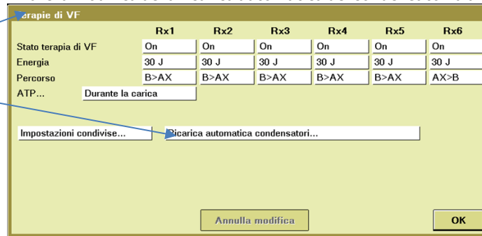
Immagine 3 – Come programmare la modifica della ricarica automatica dei condensatori a un intervallo fisso pari a 6 mesi
