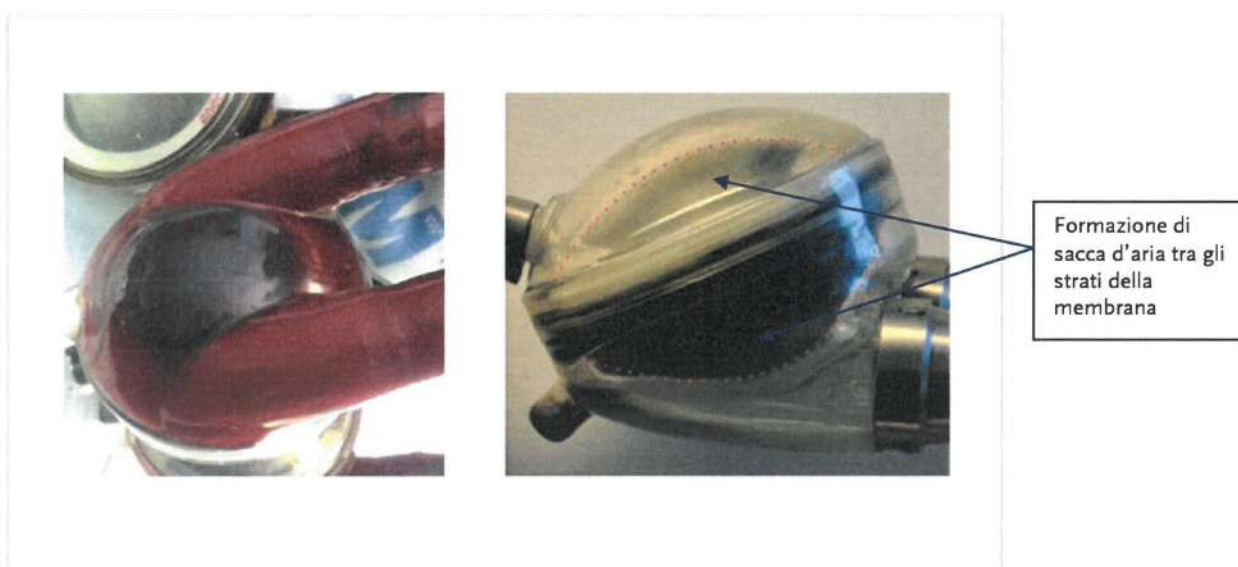
Illustrazione 2: Individuazione di un difetto sul lato pneumatico della membrana: Formazione di sacca d'aria
