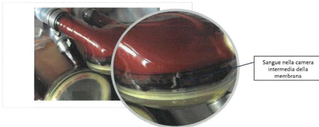
Illustrazione 3: Individuazione di un difetto sul lato ematico della membrana: Sangue nella membrana intermedia, davanti all'anello stabilizzatore
