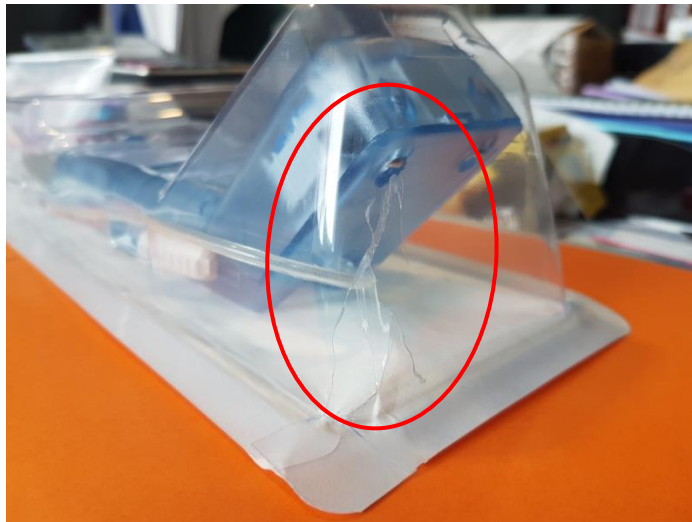
Foto 2: esempio di spaccatura osservata vicino al manometro del dispositivo di gonfiaggio
