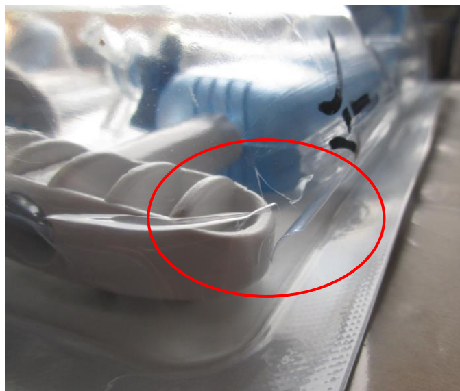
Foto 1: esempio di spaccatura osservata vicino all'impugnatura del dispositivo di gonfiaggio
