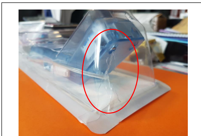
Immagine 2: Esempio di rottura osservata vicino all'indicatore di pressione del dispositivo per gonfiaggio DOLPHIN
