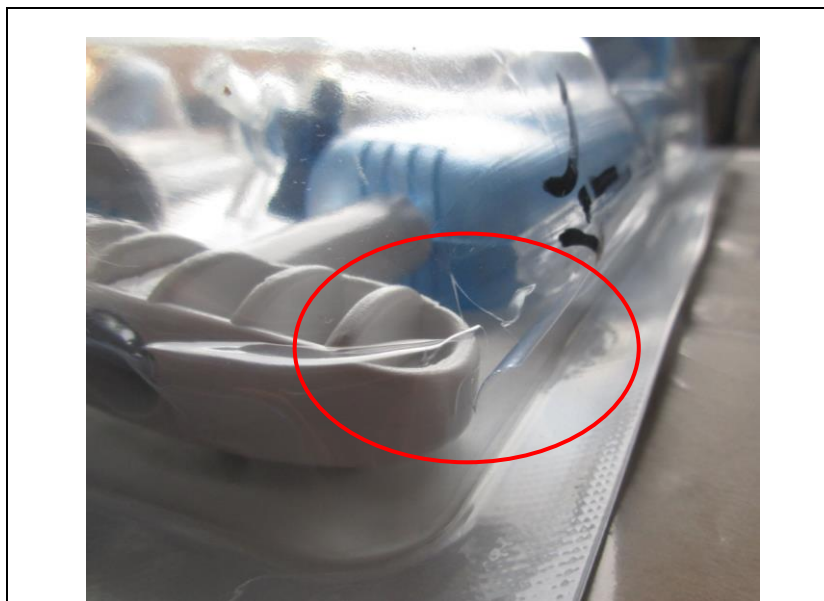
Immagine 1: Esempio di rottura osservata vicino all'impugnatura del dispositivo per gonfiaggio DOLPHIN
