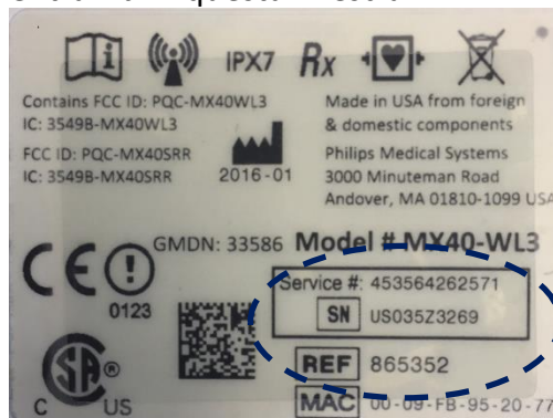
Figura 1: codice prodotto e codice 12NC sull'etichetta posizionata nella parte posteriore del dispositivo. Prego notare che il codice prodotto, indicato dopo il simbolo REF, può essere costituito da 6 o 12 numeri.
