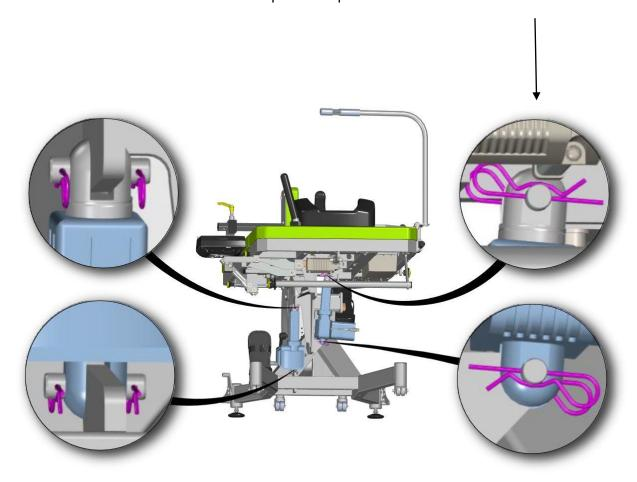
Figura 1: Attuatori lineari fissati con nuovi connettori a molla
