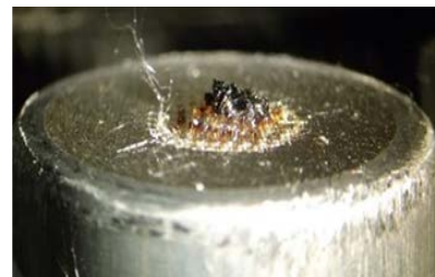
Figura 3: Cuscinetto deteriorato Si è verificata una fusione. Non utilizzare. Sostituire il cuscinetto.
