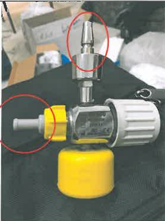
Immagine 2: Dispositivo "AV 500" falso: Sono indicati i connettori che differiscono dalle connessioni originali.
