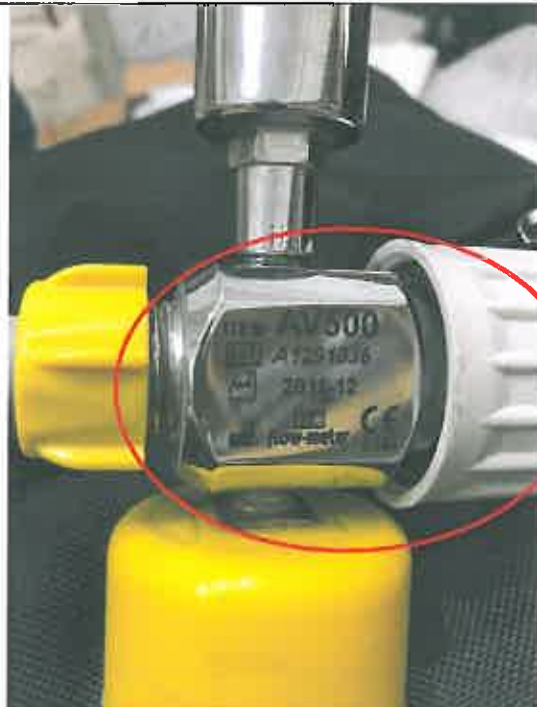
Immagine 3: "AV 500" falso: I falsi dati di rintracciabilità sono evidenziati.
