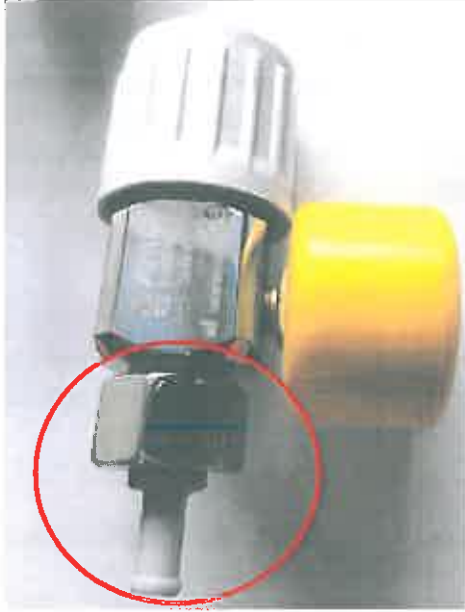
Immagine 2: Dispositivo "AV 500" falso: Sono indicati i connettori che differiscono dalle connessioni originali.
