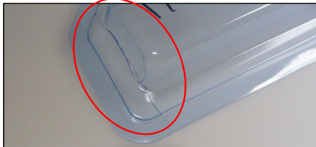
Fig. 2 Contenitore esterno danneggiato
