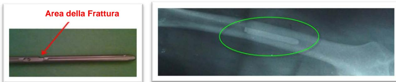
Figura 2: Immagine dell'Asta Endomidollare SP2 IM con evidenziata l'area di potenziale frattura/
