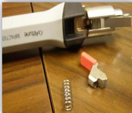
Figura 3: Manico per Impattatore INTUITION™ ATTUNE® fratturato.
