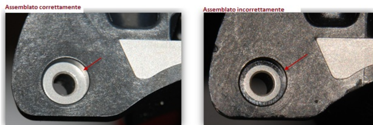
Figura 3: parte inferiore della guida (lato dell'osso) - confronto tra la guida assemblata correttamente e la guida assemblata non correttamente (boccia invertita).
