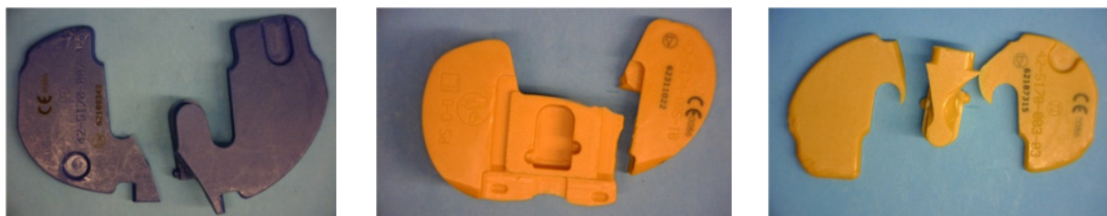
Fratture delle componenti superiore e inferiore del TASP
