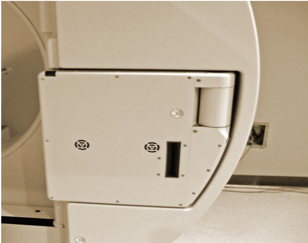
Figura 2 – Flat Panel detector (FPD) nella posizione di parcheggio
