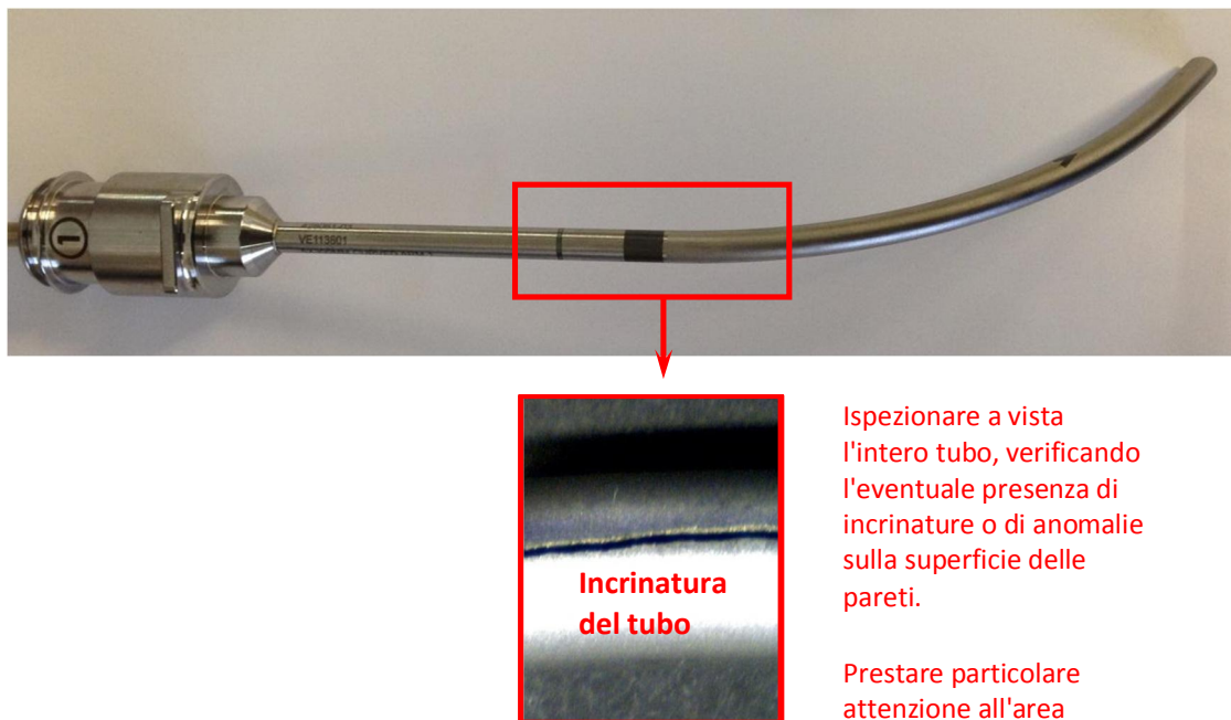
Figura 7 – Ispezione del tubo
