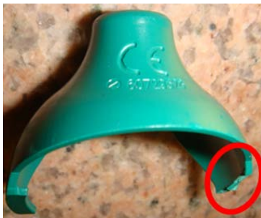
Tipica potenziale frattura dell'aletta
