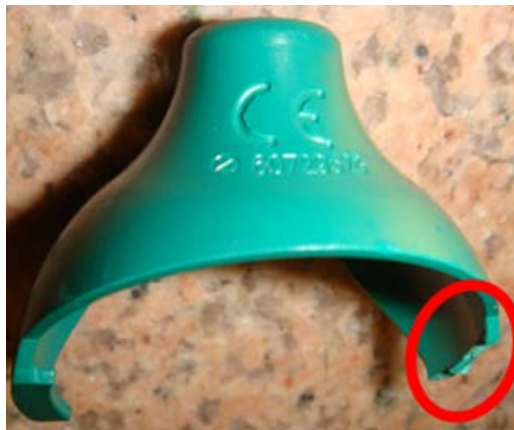
Tipica rottura dell'aletta
